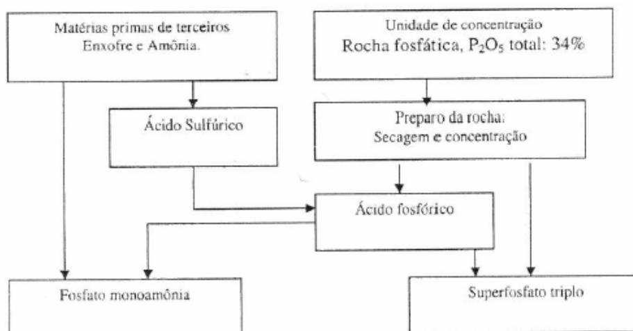
**Figura2** – Diagrama de blocos da unidade de processamento.
