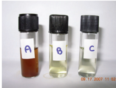
Figura 2: Hidrolisado hemicelulósico de bagaço de cana obtido por hidrólise ácida anterior (A) e posterior à destoxificação pelos métodos de alteração de pH combinado à adsorção em carvão vegetal ativado (B) e floculação por polímero vegetal (C).
