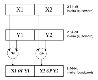
A Figura 2 ilustra a execução de uma mesma operação em vários dados, onde a operação OP
